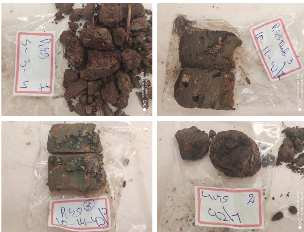
Fotos 06 a 09 – No alto, da esquerda para a direita = a) solo coluvionar, argiloso, pouco compacto; b) e c) solo residual de basaltos, argiloso, com textura maciça e d) solo residual produzido pela decomposição de rochas vulcânicas, com textura de fluxo de lavas, compacto. Fotos do autor.
